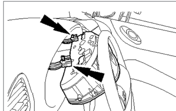
5. Stecker abziehen. Modelle ohne Bordcomputer verfügen nur über einen Stecker.
