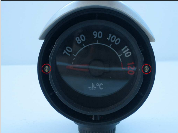
2 Torx 5 Schrauben lösen
