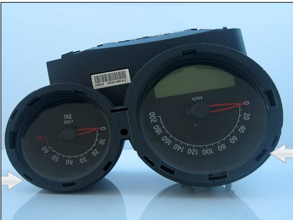
mit Schlitzschraubendreher anheben
