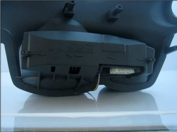
2 Torx 10 Schrauben lösen
