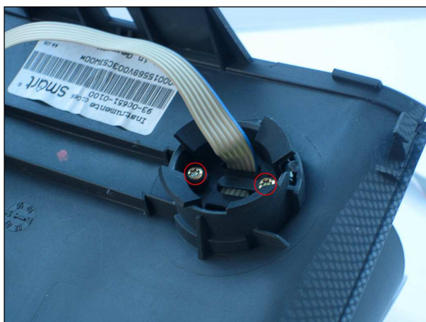
Zusatzinstrumente: 2 Torx 6 Schrauben lösen
