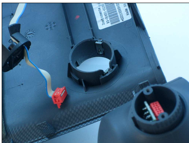
Zusatzinstrumente: 2 Torx 6 Schrauben lösen
