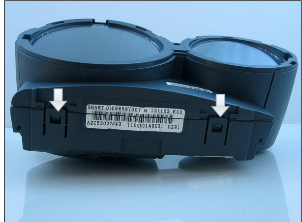
mit Schlitzschraubendreher anheben
